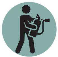
Colócate a 3 metros de distancia del conato de incendio y presiona la palanca de accionamiento emitiendo descargas intermitentes en zig-zag a la base del fuego.
